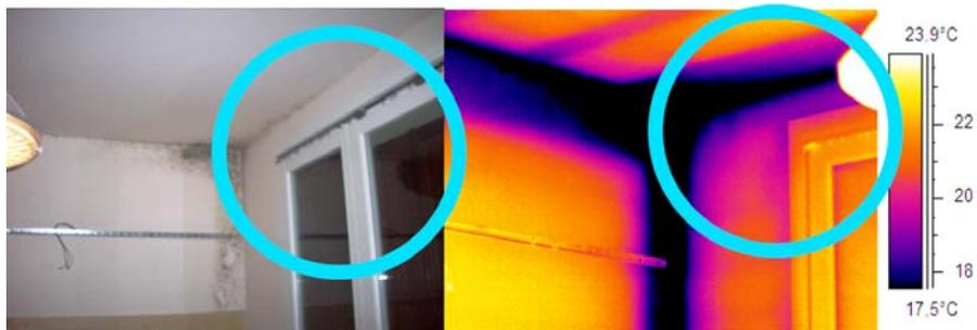
MISURE IR: INDIVIDUAZIONE PERDITE IDRAULICHE
