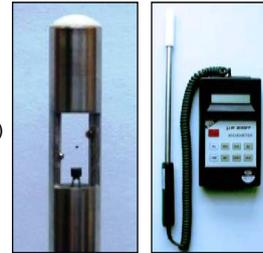
Sonda per misure di turbolenza ( $T_u$ )
